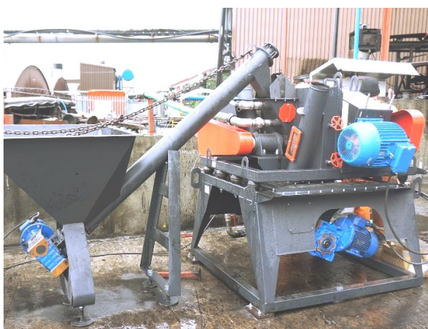
Гидроударный Узел Мокрого Помола (ГУУМП) для подготовки сырья (Стадия 1)
